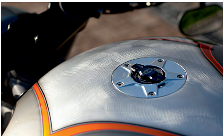
Kein Plastik, kein Gfk, nicht einmal Carbon: Auch der Tank besteht aus Aluminium
