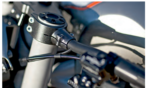
Ebenfalls von Custom-Wolf: aufwändig gefräste Gabelbrücke, zweiteiliger Lenker direkt angeklemt
