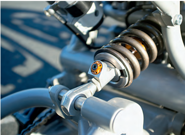
Direkt an der Cantilever-Schwinge: das Federbein von WP Suspension
