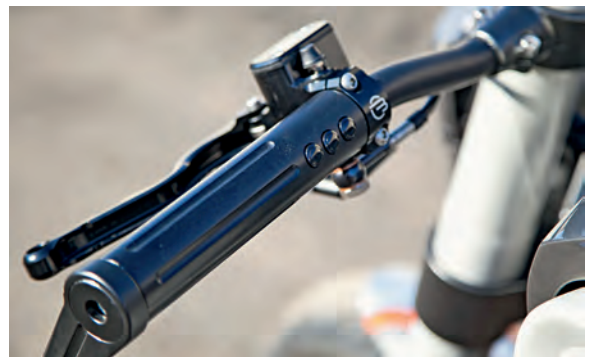
Schlank und sauber: spezielle Griffe von Custom-Wolf, hier kombiniert mit Hydraulik-Armaturen von Beringer
