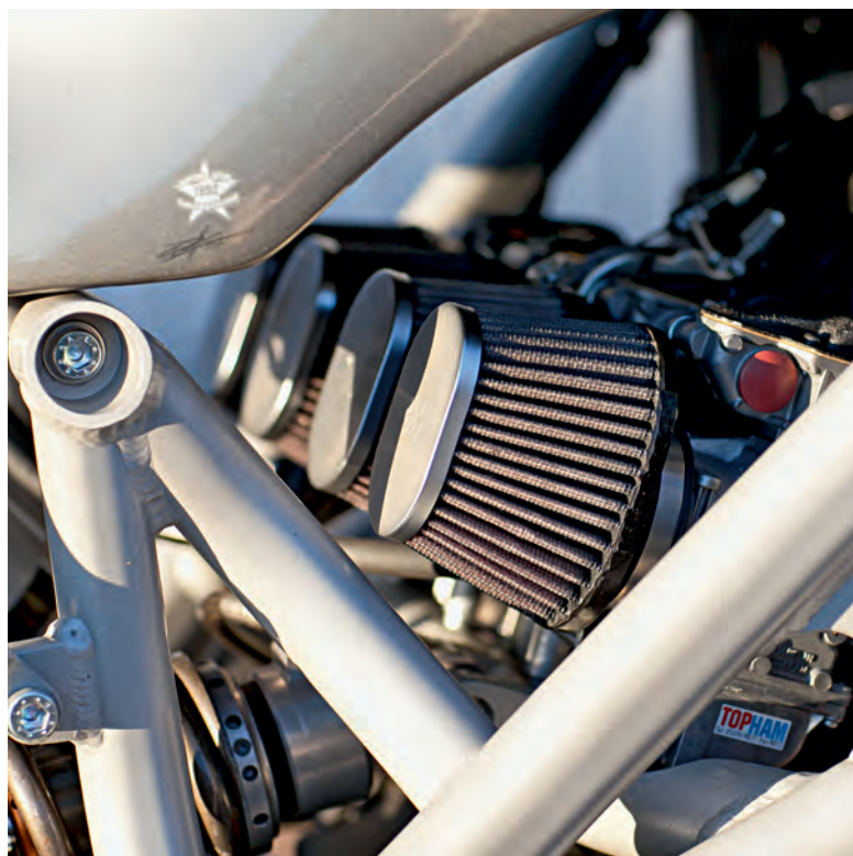
Vier von Topham optimierte Mikuni-Flachschieber mit vier K&N-Luftfiltern
